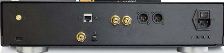
**SELBSTERKLÄREND:** Ganz links oben kann man bei Bedarf eine WLAN-Antenne festschrauben, darunter USB-Sticks einstecken. Weiter rechts folgen die Digitalausgänge, darüber die Ethernet-Buchse und rechts der Mitte schließlich die Cinch- und XLR-Analogausgänge. Digitale Eingänge hat der Connect leider nicht.
